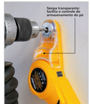
6. Posicione o coletor no local marcado, insira a broca através da abertura e realize a perfuração
