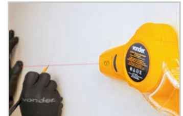
4. Use o nível laser para auxiliar na marcação dos furos
