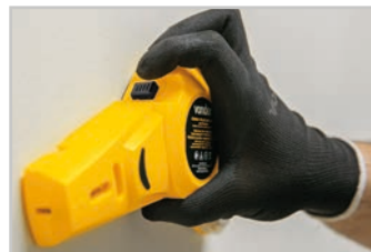
5. Pressione o botão de liberação e tire o aparelho da parede
