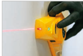
2. Posicione o coletor em superfície plana, ligue o interruptor do laser e use o nível bolha vertical ou horizontal para alinhar o equipamento
